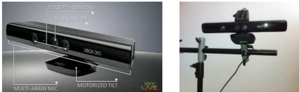
Figura 8. Detalle de una de cámara Kinect y de su colocación.
